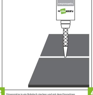
Düsenspitze in ein Bohrloch stecken und mit dem Einspritzen beginnen. Fliesenhohlraum füllen, bis etwas Injektionsharz wieder beim Bohrloch hochkommt.
