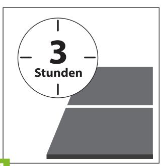
Nach 3 Stunden Trocknungszeit können die Bohrlöcher wieder verfugt werden. Nach 3 Stunden kann man auch wieder (vorsichtig) auf dem Boden laufen.
